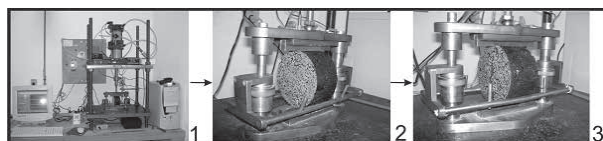
Figura 5. Ensayo de Fatiga por compresión diametral
