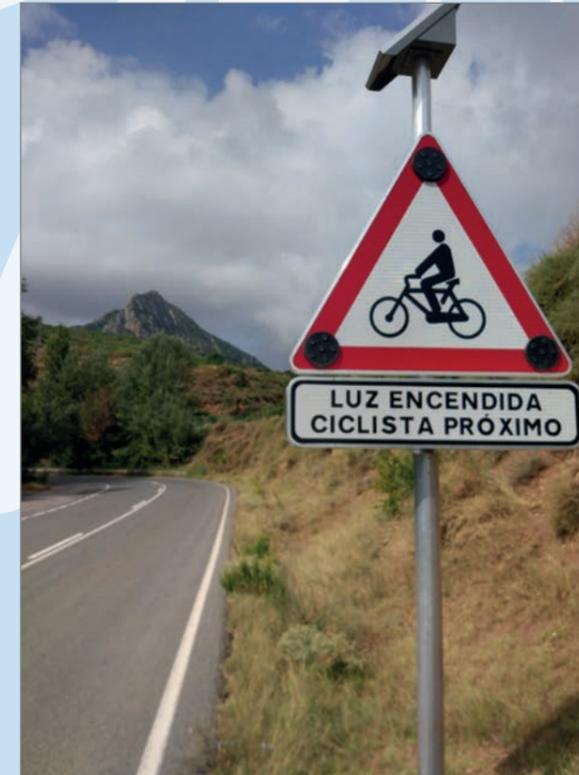
Foto 9. Señalización dinámica de aviso de presencia de ciclistas en vías frecuentadas por ciclistas. (Fuente: DGT).
